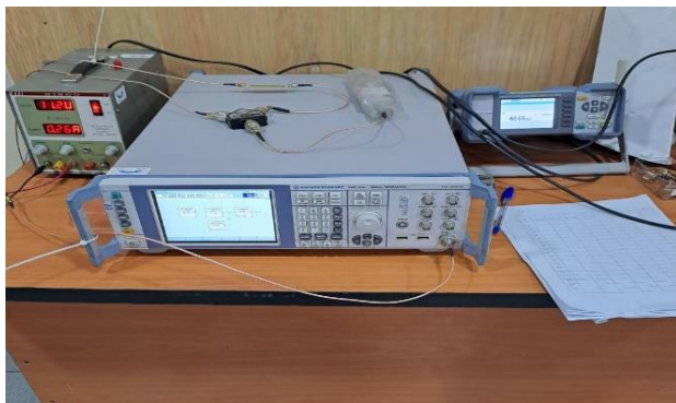
شکل (۵): نحوه اندازه گیری دامنه میدان نزدیک.
