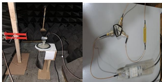
شکل (۲): نحوه اندازه گیری داده های میدان نزدیک.
