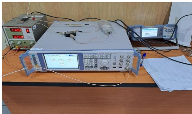
شکل (۵): نحوه اندازه گیری دامنه میدان نزدیک.
